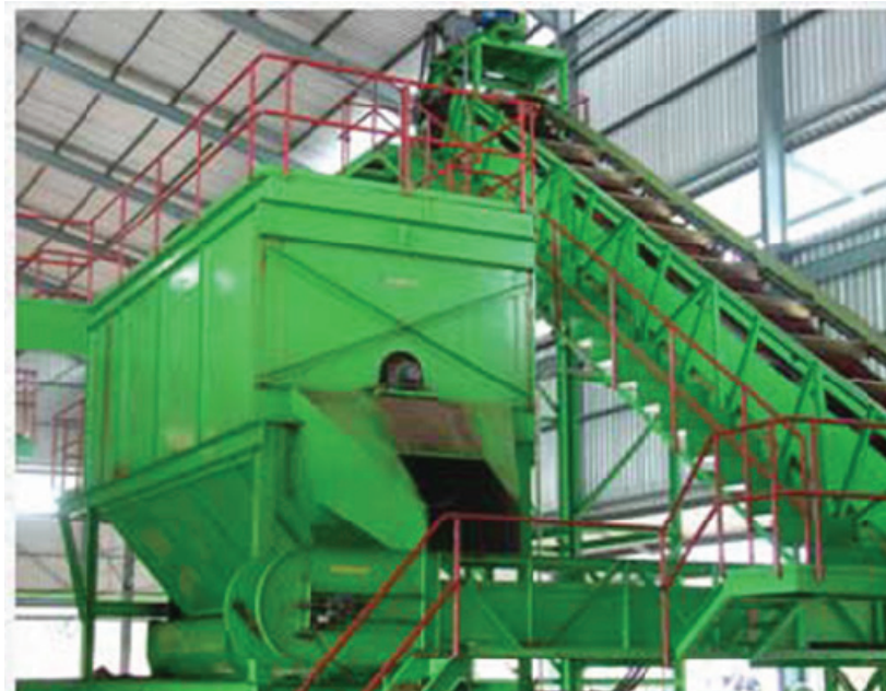
รูปภาพที่ 11 เครื่องนวดทะลายนวลแยกผลนวลออกจากทะลายนวล
