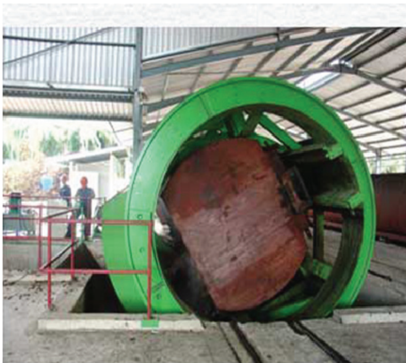
รูปภาพที่ 10 เกล่งสายพานเพื่อลำเลียงเข้าเครื่องนวดทะลายปาล์ม (Bunch Thresher)
