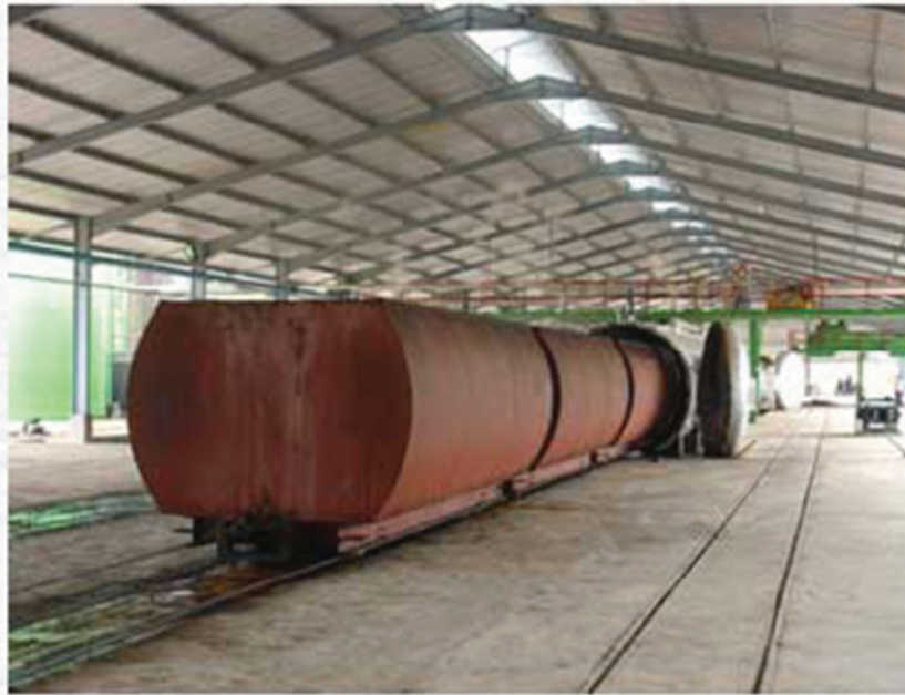
รูปภาพที่ 9 ลำเลียงผลิตผลปาล์มน้ำมันที่ผ่านการนึ่งสุกแล้วออกจากหม้อนึ่งไอน้ำ
