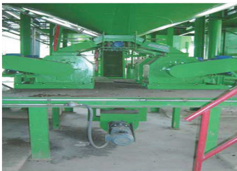
รูปภาพที่ 22 นำเมล็ดปาล์มเข้าเครื่องกะเทาะเมล็ด (Ripper Mill) เพื่อแยกกะลาออกจากเมล็ดในปาล์ม
