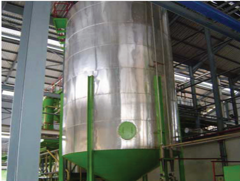
รูปภาพที่ 16 นำน้ำมันปาล์มดิบเข้าเครื่องกรองน้ำมันเพื่อแยกน้ำออกจากน้ำมัน
